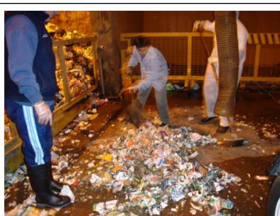
Foto 9 – Detalle de Homogenización del material triturado
