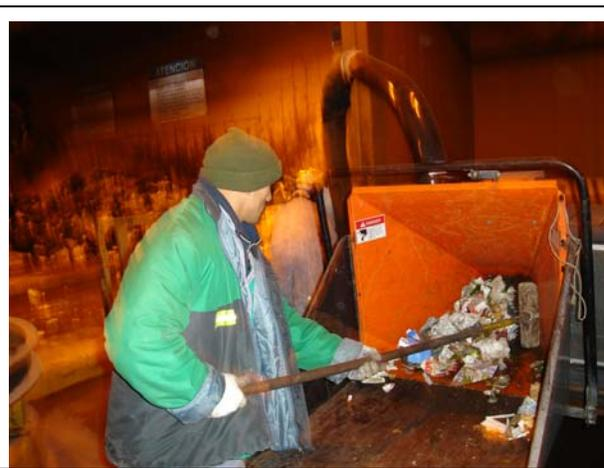
Foto 8 – Detalle de Carga de Materiales para trituración
