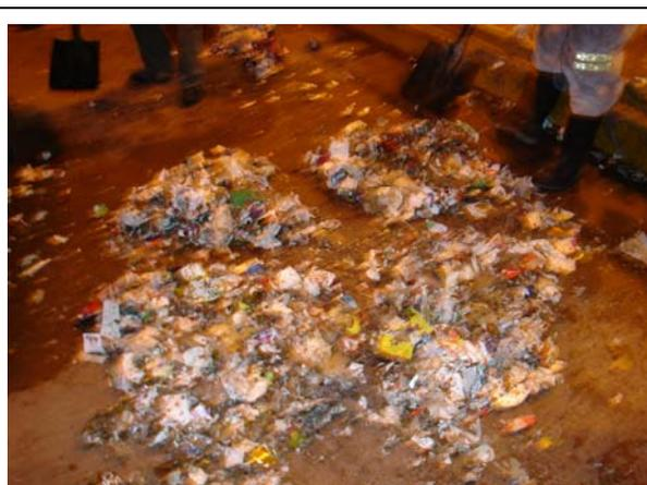
Foto 10 – Detalle de Cuarteo del material triturado
