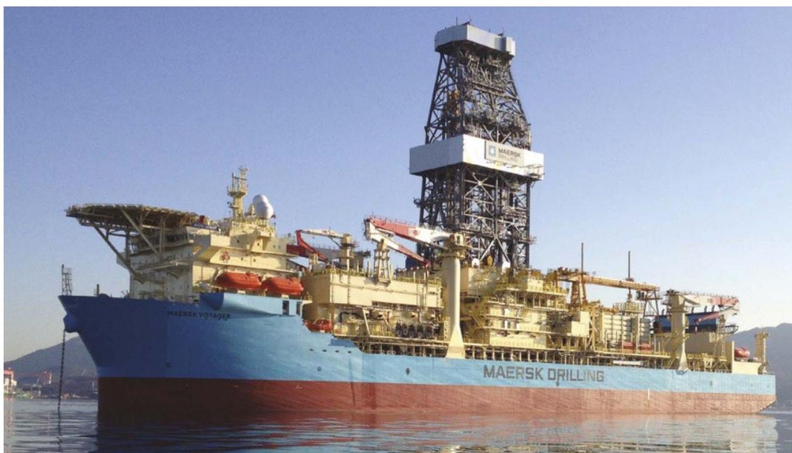
Se caracteriza por tener una torre desde donde se desprende la broca y los tubos, y posee sistemas de posicionamiento dinámico y helipuerto.
