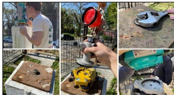
Figura 2: Sistema de centrado forzado.
