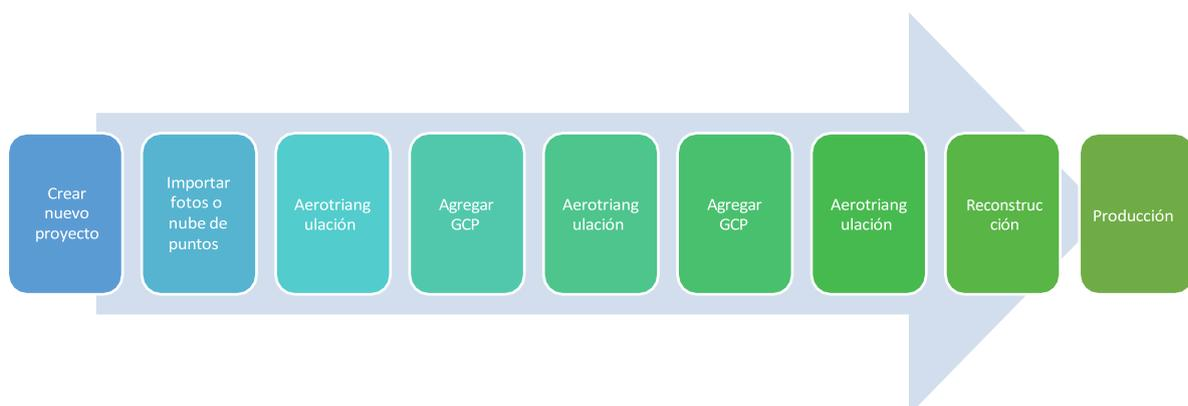
Figura 1: Diagrama de flujo del proceso fotogramétrico.
