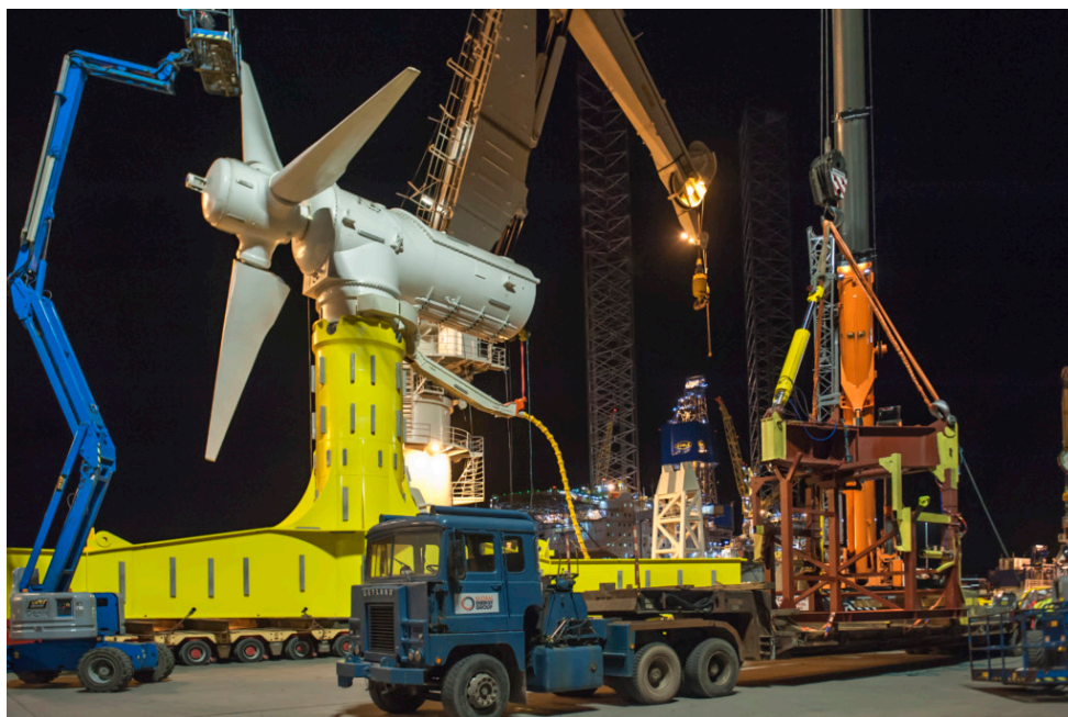
Fig. 4. Turbina Atlantis de 1,5 MW de potencia nominal; proyecto MeyGEN 2
