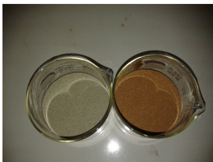
Fig. 1. Muestra de zeolita natural NZ (izq.) y de zeolita modificada con Fe NZ-A-Fe (der.)
