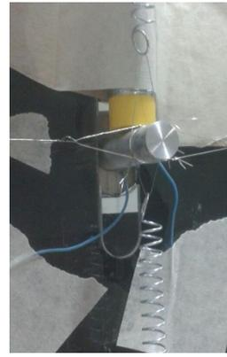
Ilustración 6 - Sensor de posición
