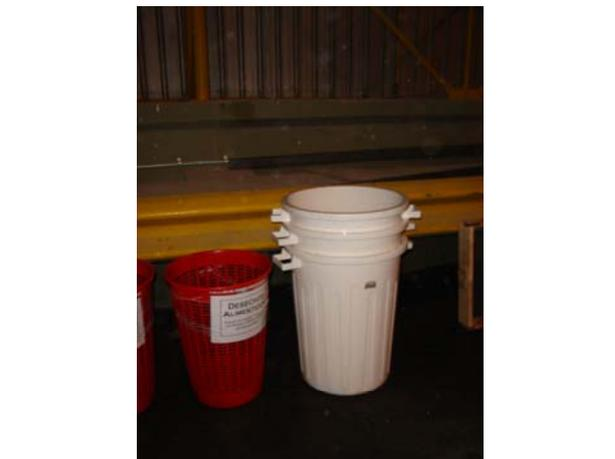
**Foto 6 - Detalle de contenedores para determinación de Peso Volumétrico**
