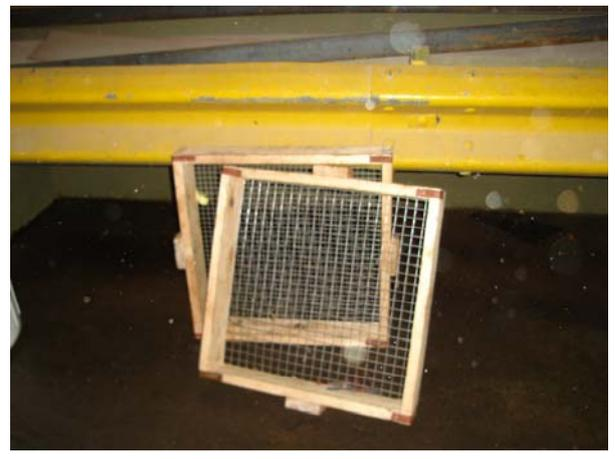
**Foto 4 – Detalle de Zarandas para separación y clasificación de misceláneos**
