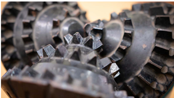
Un elemento fundamental al perforar pozos, lo representan los trépanos, en este caso del tipo “triconos”.
