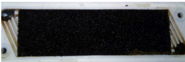
Fig. 2: Compartmento de electrodo con lecho de partículas de coque cubierto con tinta de LMO, del reactor filtro prensa FM01-LC (arriba). Compartmento de electrodo con malla de titanio cubierta de tinta de LMO, del reactor de electrodos planos (abajo).
