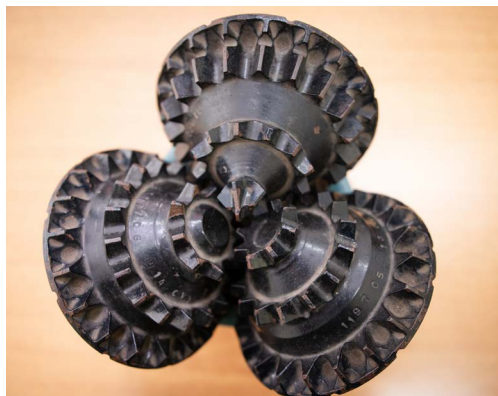
Un elemento fundamental al perforar pozos, lo representan los trépanos, en este caso del tipo “triconos”.
