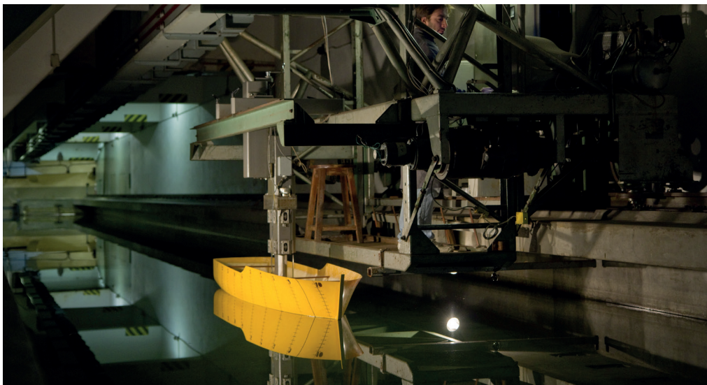
Ensayo de resistencia al avance en aguas tranquilas.
