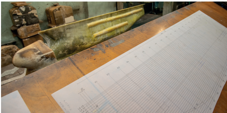
Arriba: Plano de líneas del buque para el tallado del modelo, en parafina, con la fresa copiadora.
