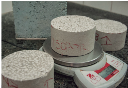
Probetas de hormigón con EPS: material de relleno liviano para paneles aislantes prefabricados.
