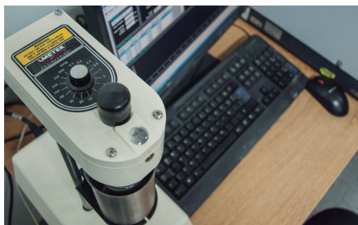
Viscosímetro tipo Brookfield acoplado a un software diseñado para estudiar la reología de lechadas de cemento para petróleo.
