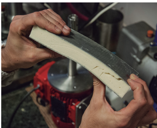
Panel sandwich con núcleo de poliuretano nanoestructurado con celulosa bacteriana.
