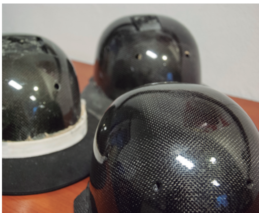
Cascos de polo de fibra de carbono con matrices nanoestructuradas.
