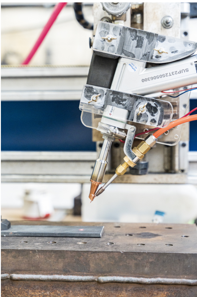
Arriba: Soldadura láser de punto en anillo separador.
