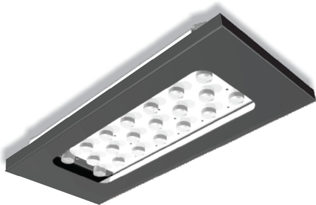
Como se ve en la fotografía, el artefacto modelo **IBA 637** consta de vidrio templado de protección, sellos mediante burletes para lograr la hermeticidad, y disipador de aluminio extruido que evita el sobrecalentamiento de los leds.
