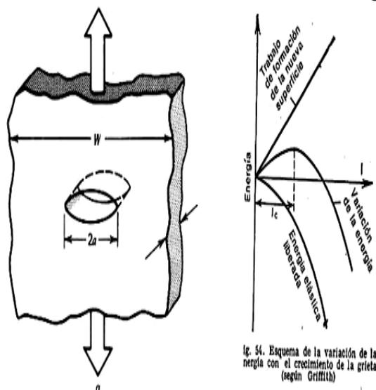
Fig. 54. Esquema de la variación de la energía con el crecimiento de la grieta (según Griffith)
